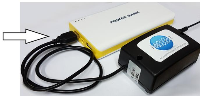
RECUERDE QUE EL MÓDULO WIFI, AL DISPONER DE CONEXIÓN USB, SE PUEDE ALIMENTAR TANTO CON UN CARGADOR DE CELULAR USB (DE 1 O 2 AMPERS) COMO CON EL BANCO DE BATERÍA (POWER BANK).
